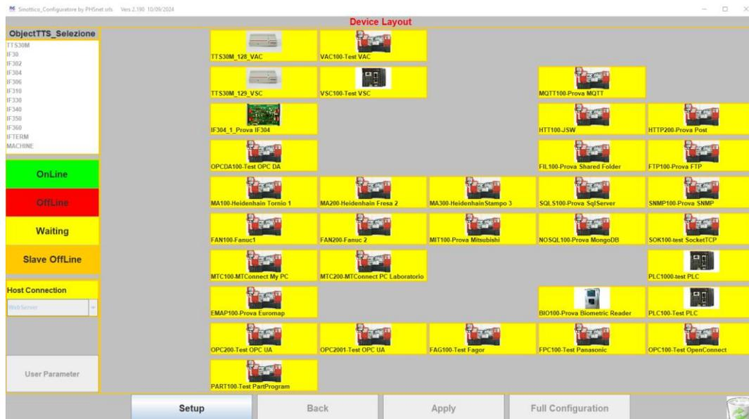
viene trasposto in OPC UA in due oggetti: **Machine** (dispositivi dotati di un protocollo) e **TTSObject** (dispositivi della PHSNET).
